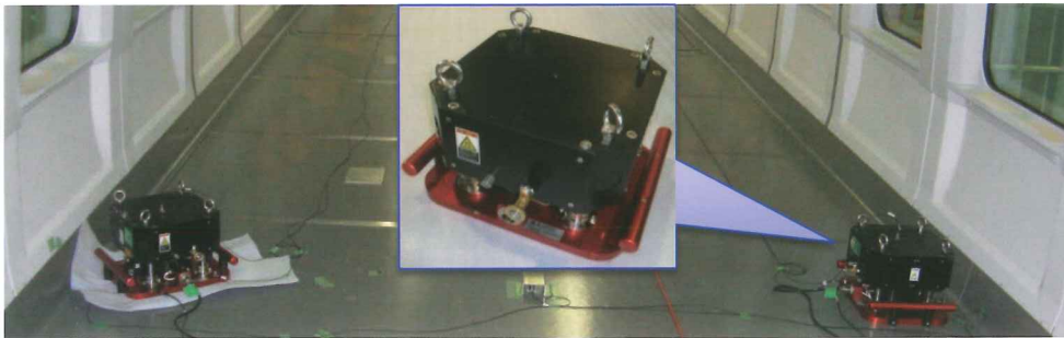
AMDの設置状況
