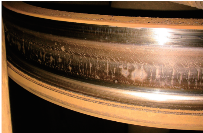
図1 実車における車輪踏面熱き裂の例
