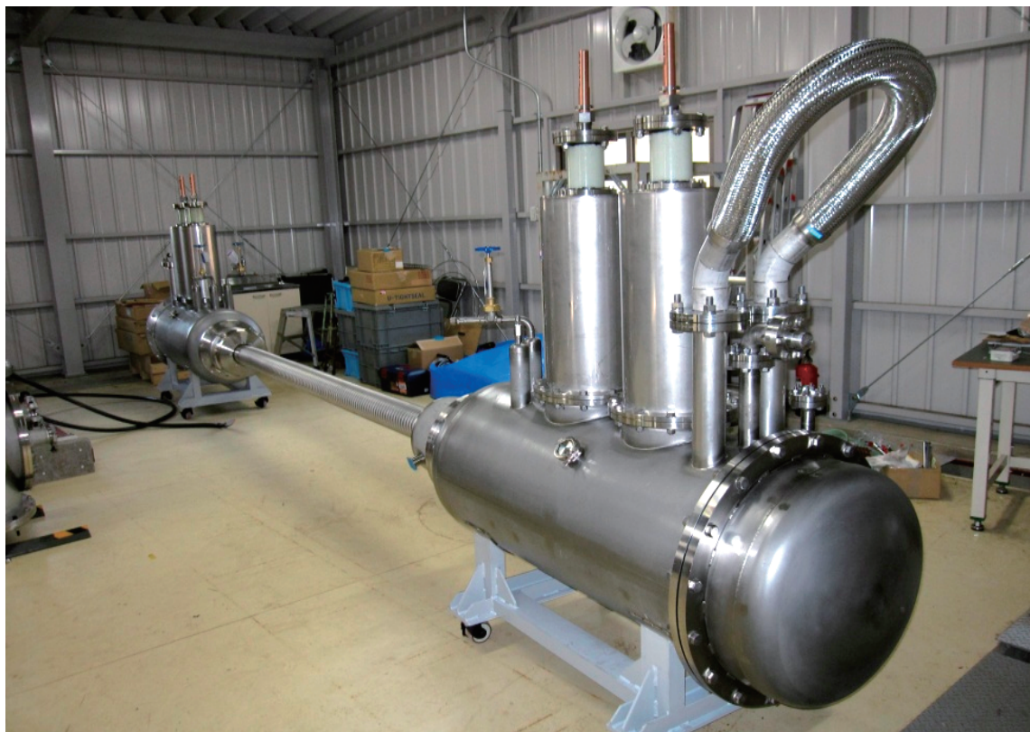
鉄道用超電導ケーブル試験装置
