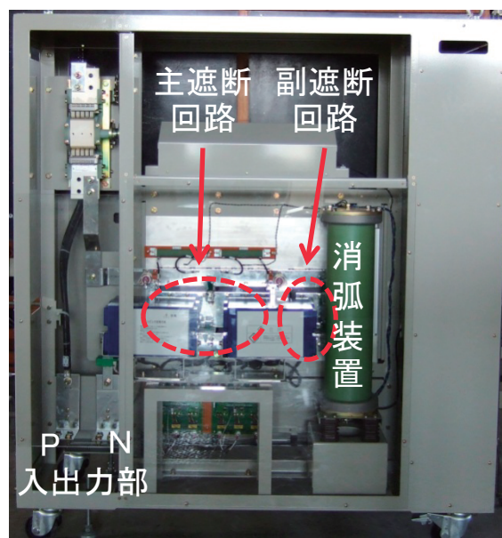
図1 遮断器ミニモデルの構造
