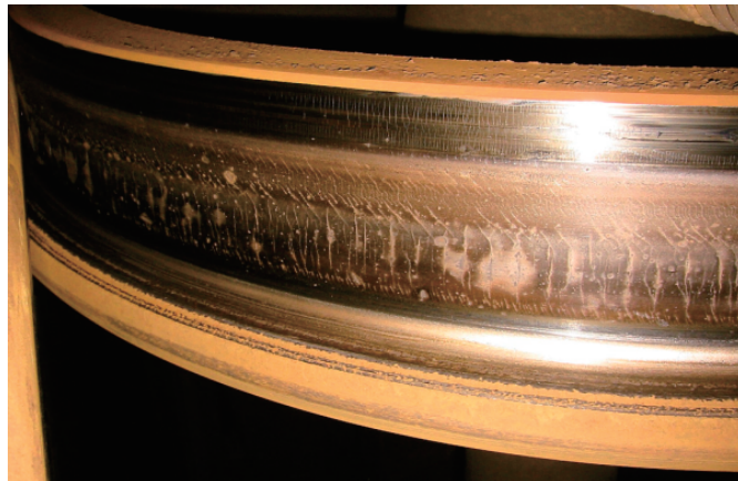
図 1 実車における車輪踏面熱き裂の例
