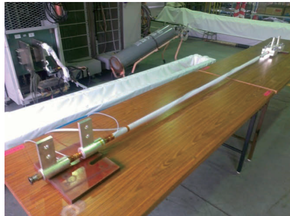
2m級Y系超電導ケーブルの仕様と外観写真
