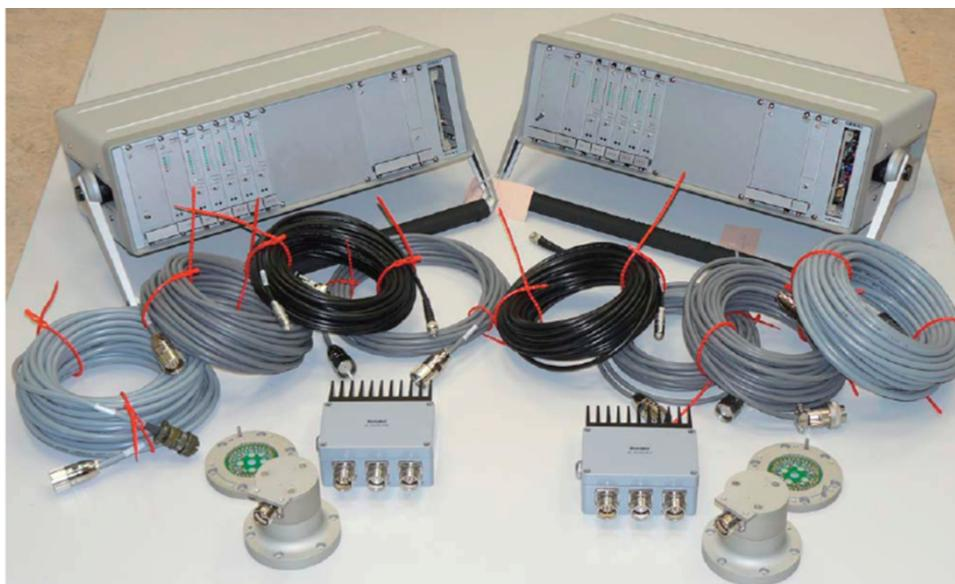
開発した8ch歪み用軸端テレメータ装置一式
