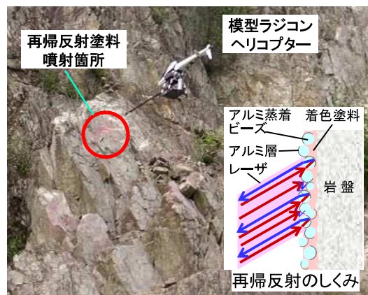
模型ラジコンヘリコプターによる反射ターゲット形成状況
