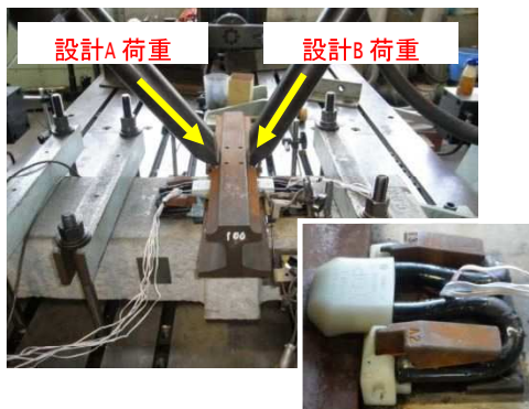
性能確認試験
