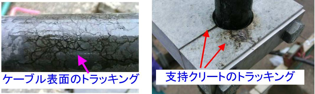
図1 電気的劣化の例
