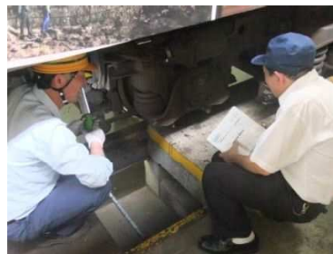
車輪のフランジ摩耗に関する現地調査
