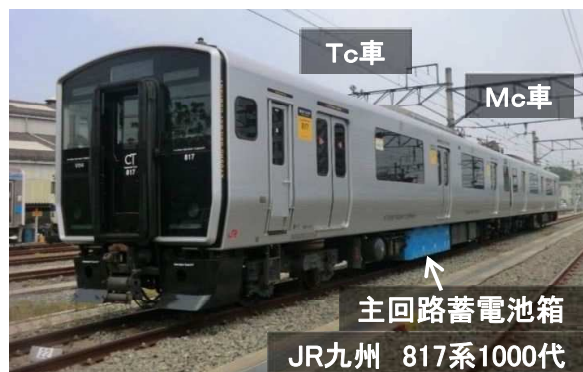
蓄電池電車(試験車)の外観
