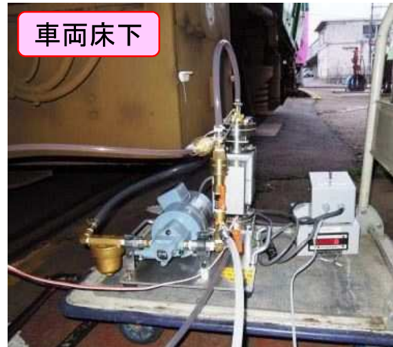
図2: オンライン鉄粉センサを組み込んだ定置試験装置を使用した現車測定(変速機油の測定)
