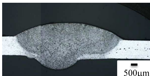
500μm TIG溶接材の断面マクロ観察
