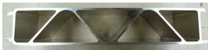
中空押出型材の外観(改良試作) 50mm (押出加工しやすい型材の断面形状に改良)
