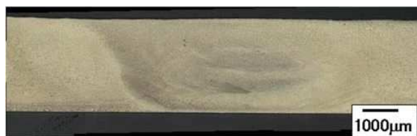
1000μm 摩擦攪拌接合(FSW)の断面マクロ観察
