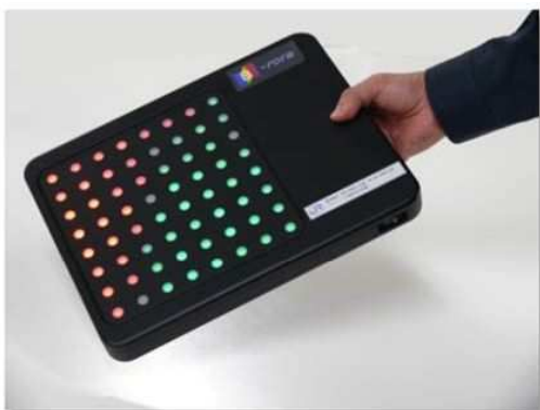
磁界可視化装置 (鉄道総研開発)
