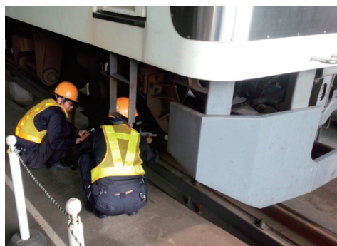
車輪のフランジ摩耗に関する現地調査
