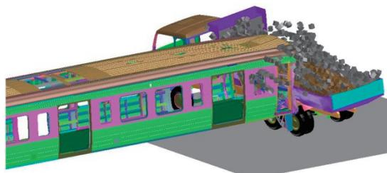
図1 列車衝突解析例(衝突速度54km/h)
