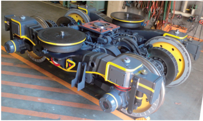
輪重減少抑制台車の外観と主要諸元
