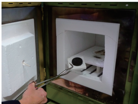
レアアース系超電導バルク材の 製作状況
