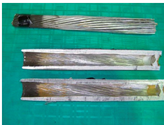
電車線金具解体調査
