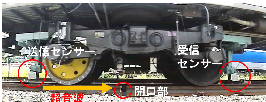
非接触空中超音波システムを搭載した試験車両
