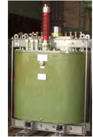
超電導主変圧器
