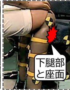
スレッド試験※2による事故時の 傷害発生状況の推定
