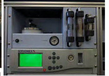
酸素分析計による 発熱速度の測定
