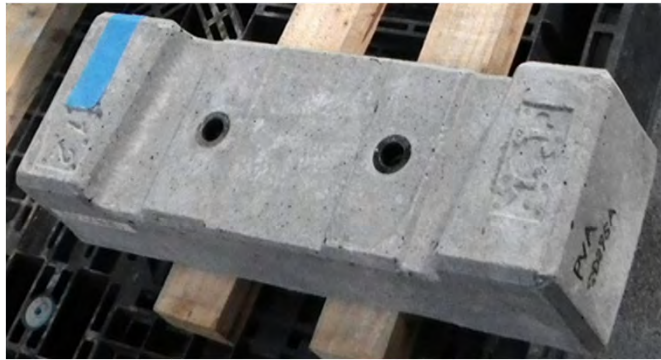
鉄筋を減らした短まくらぎを試作 (鉄筋組立工程を簡素化)
