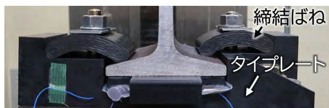
直結8形(FRTP製タイプレート+CFRP締結ばね)
