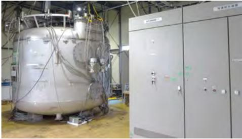
超電導磁気エネルギー貯蔵装置(SMES)
