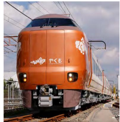
次世代振子制御システムが搭載されたJR西日本273系直流電車
