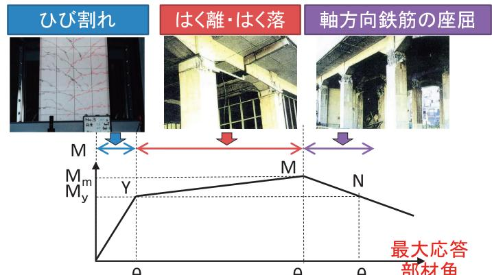
▼最大応答部材角と柱の損傷レベルの関係は概ね把握
