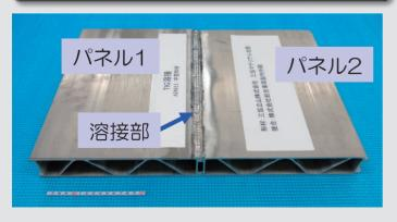
溶接例(溶接:株式会社総合車両製作所)
