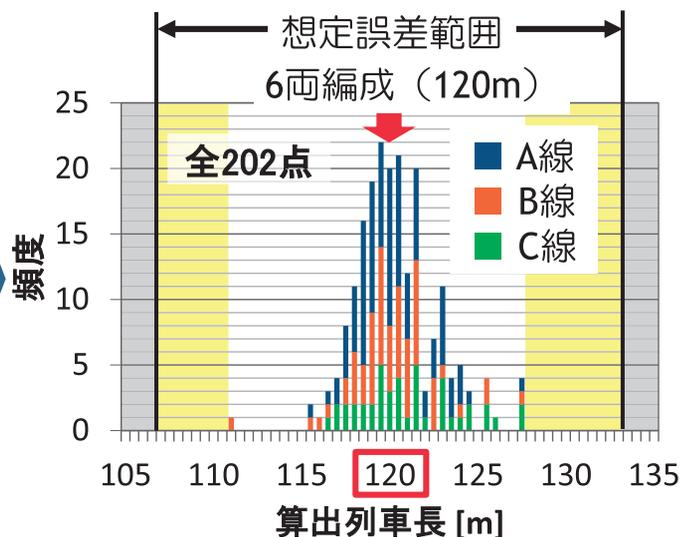
無線式列車制御の間隔制御で重要となる列車長の算出が可能
