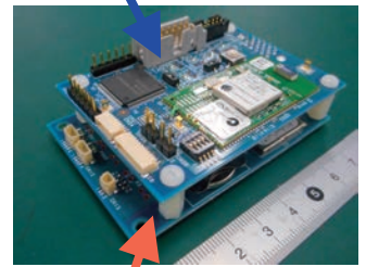
下段 電源供給部
