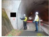
・無線機のアンテナは高さ3mに設定、 壁面に接するように配置 計測は20mピッチにて実施
