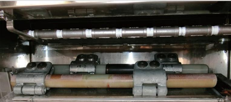
10年相当の紫外線照射後、耐滑り荷重試験を実施し、耐滑り荷重仕様値の満足を確認
