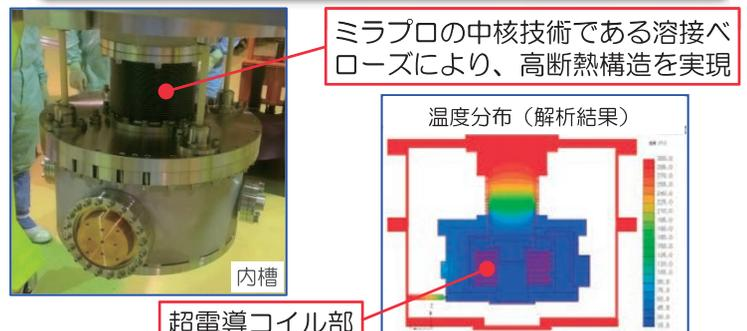
ミラプロの中核技術である溶接ベローズにより、高断熱構造を実現
