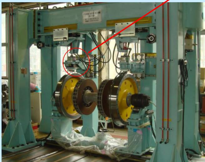
写真1 PQ軸検定装置外観
