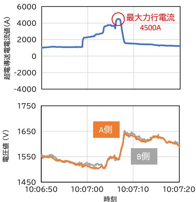
力行電力送電時の電流・電圧例
