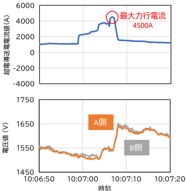
力行電力送電時の電流・電圧例
