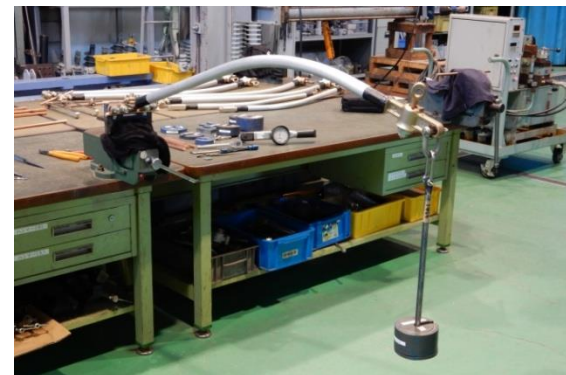
曲線引金具の耐ねじり荷重試験
