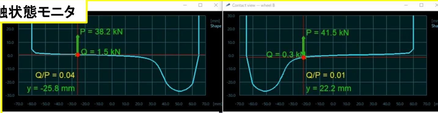
接触力測定波形
