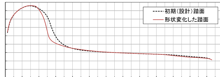
フランジ部が摩耗した踏面形状の例
