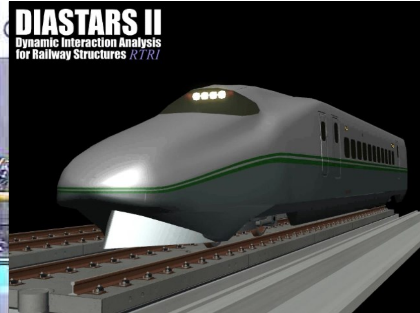
脱線直前までの車両挙動解析
