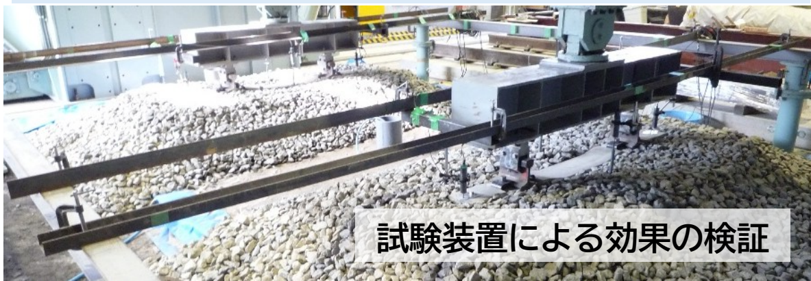
試験土槽 (L:7m×W:3.5m×H:2.5m)
