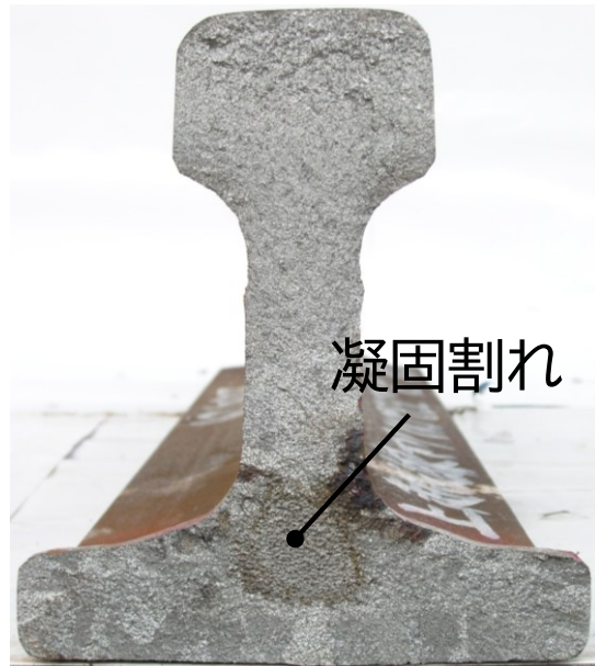
凝固割れの破断面
