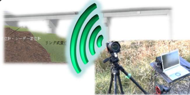
Uドップラー/橋りょう 変状計測システム
