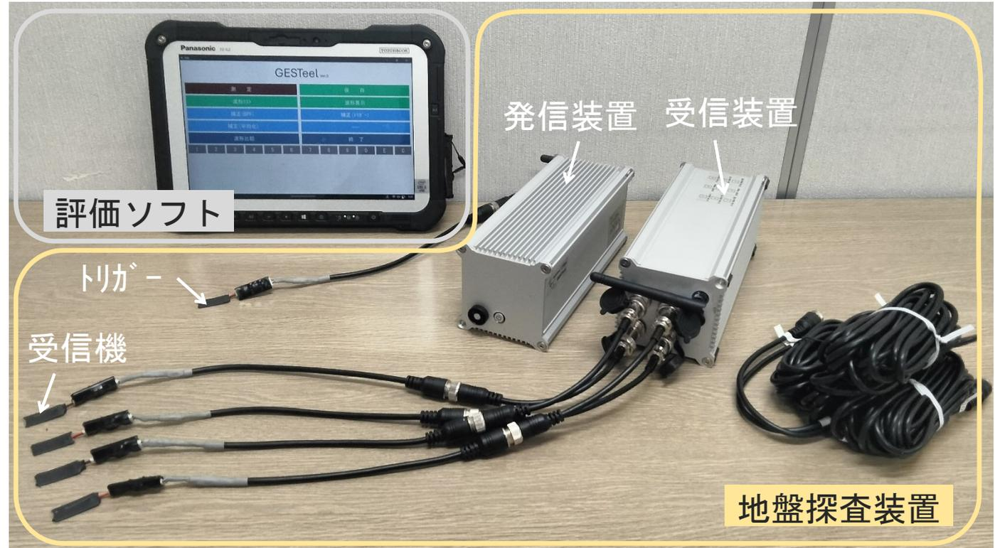
地盤緩み検知による軌道変状推定システム
