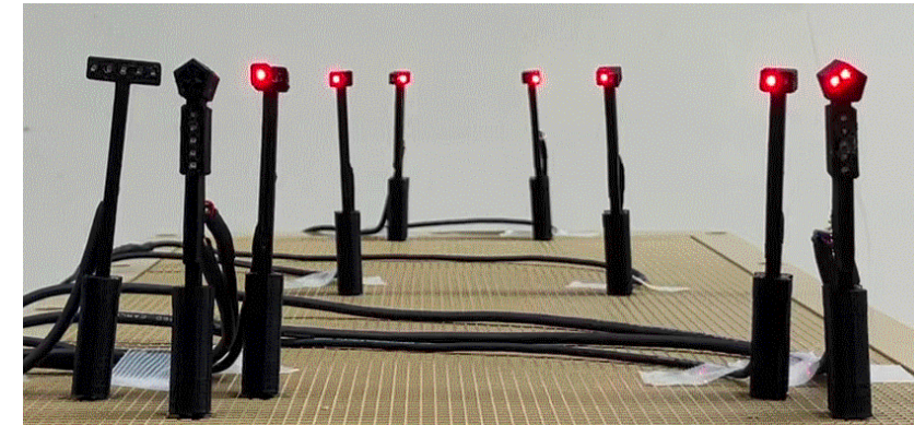
踏切警報灯発光中
