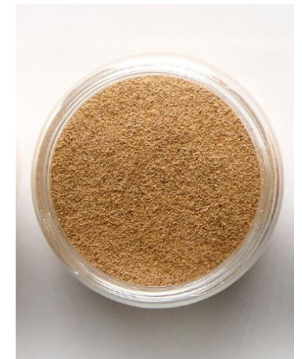
模擬雪粒子 (粒径 125\mu\text{m} )
