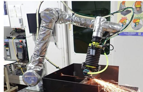
(b) ロボットアームによるふくらみの研削
