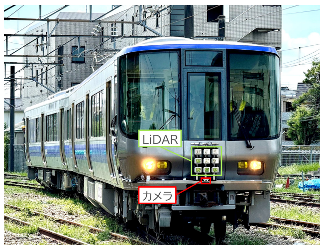
図9 鉄道総研試験車両への前方監視装置の仮設
