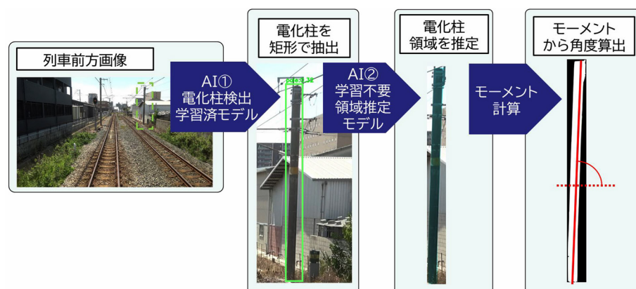
図4 車載カメラによる沿線設備の診断システム(電化柱の傾き推定への適用例)
