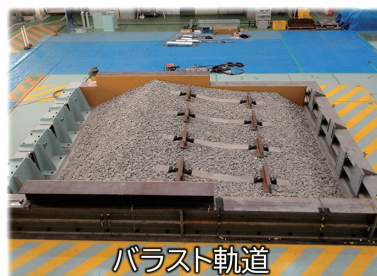
図4 フィジカル技術(鉄道システムの地震時の安全性向上のための振動台試験装置)
