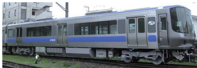
図8 水素燃料電池ハイブリッド試験電車と社会実装に向けたナレッジ活用
